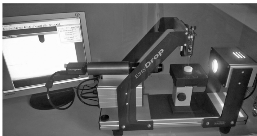
Рис. 1. Установка Easy Drop Standard DSA15E
